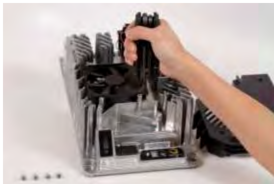
Figure 63: Remove Fan Screws and Fan
